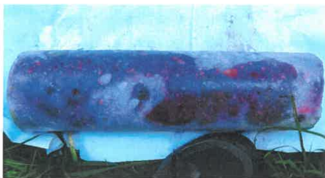
Fot. 30 Próbka rdzeniowa B.1 pobrana z podpory B po badaniu karbonatyzacji.
