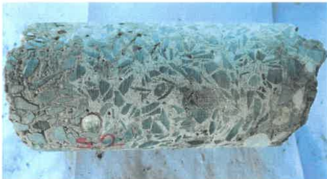
Fot. 28 Próbk rdzeniowa S.2 pobrana z podpory S. Fot. 29 Zbliżenie na strukturę betonu próbki S.2.
