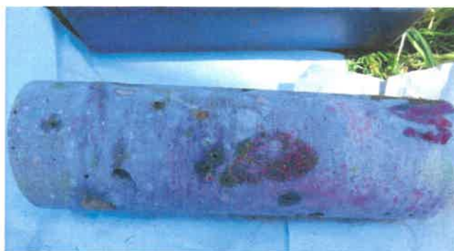
Fot. 31 Próbka rdzeniowa B.2 pobrana z podpory B po badaniu karbonatyzacji.
