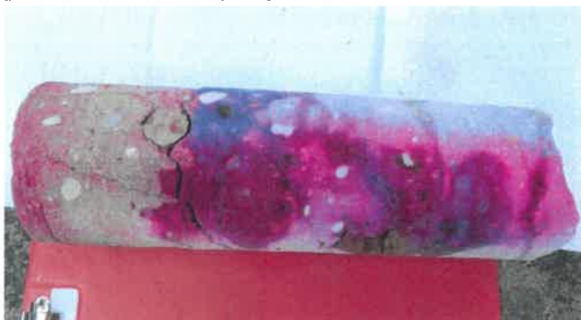
Fot. 32 Próbka rdzeniowa F.1 pobrana z podpory F po badaniu karbonatyzacji.
