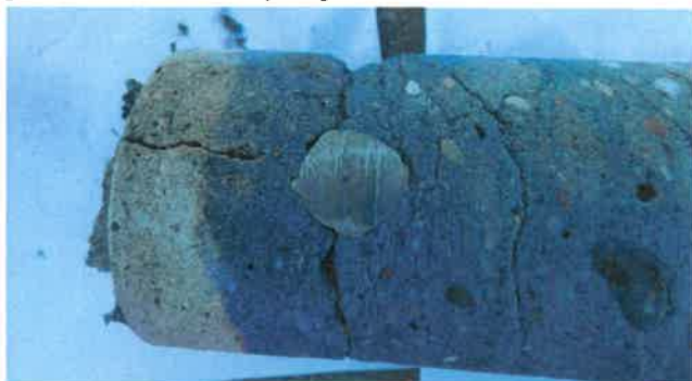
Fot. 35 Próbka rdzeniowa L.2 pobrana z podpory L po badaniu karbonatyzacji.
