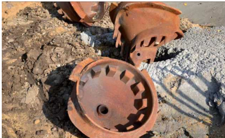
Rys.1 Ostrze tracone pale przemieszczeniowego.
