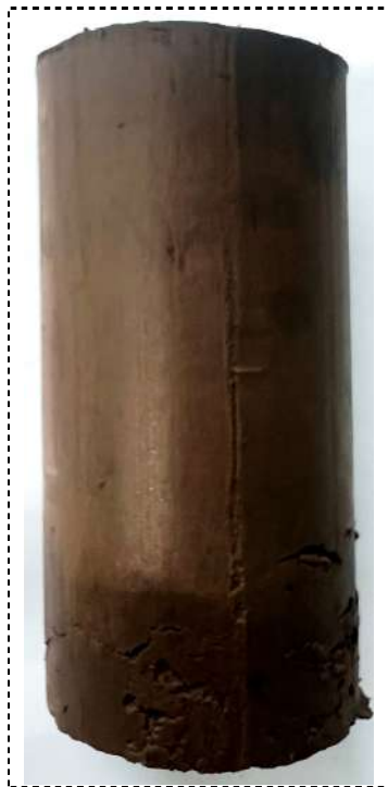
Zdjęcie – próbka C przed ścięciem
