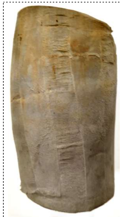
Zdjęcie – próbkka B po ścięciu
