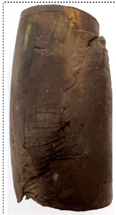
Zdjęcie – próbka B po ścięciu
