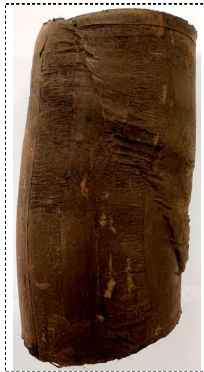
Zdjęcie – próbka C po ścięciu
