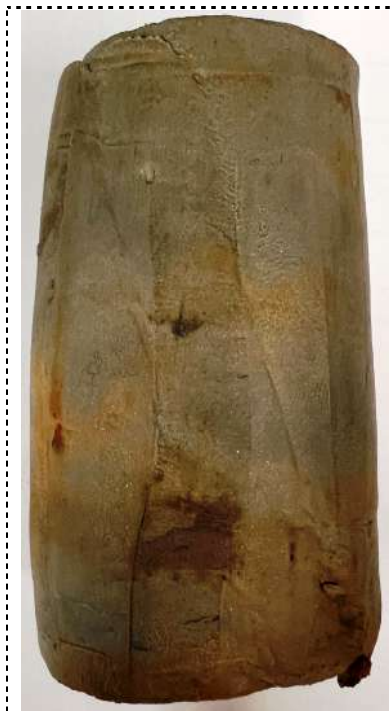
Zdjęcie – próbka C po ścięciu
