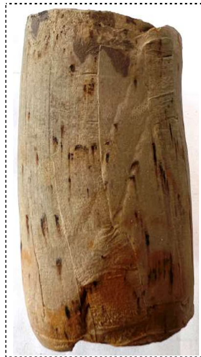
Zdjęcie – próbka C po ścięciu
