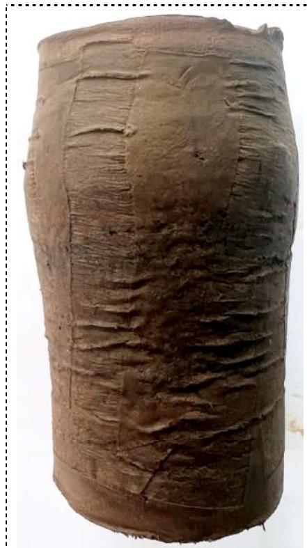
Zdjęcie – próbka A po ścięciu
