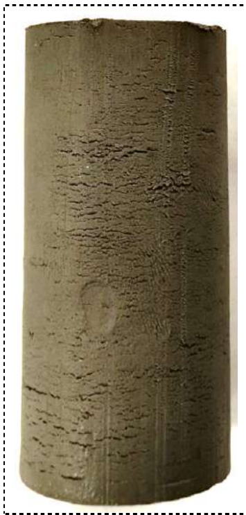
Zdjęcie – próbka A przed ścięciem
