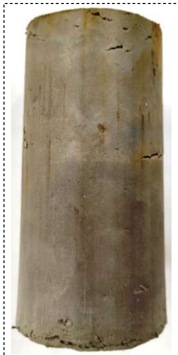
Zdjęcie – próbkka B przed ścięciem
