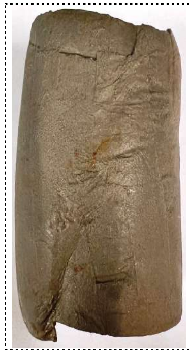
Zdjęcie – próbka A po ścięciu
