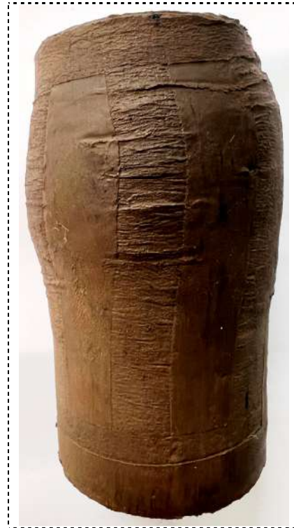
Zdjęcie – próbkka B po ścięciu
