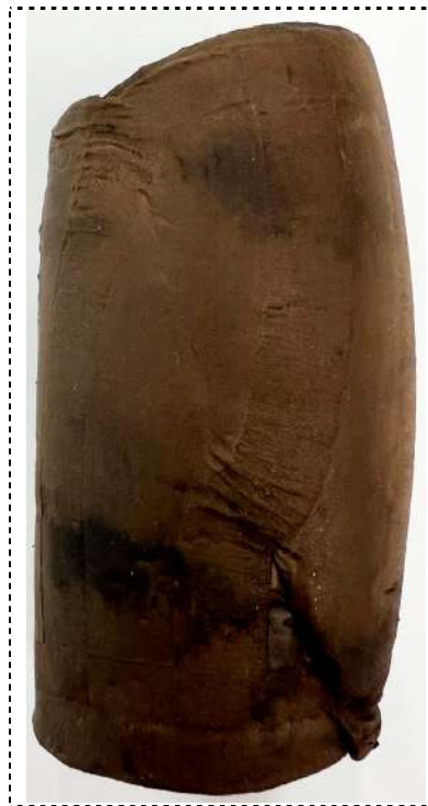
Zdjęcie – próbka C po ścięciu
