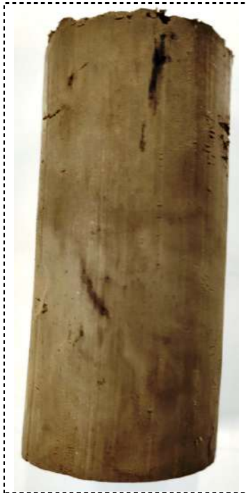
Zdjęcie – próbka C przed ścięciem
