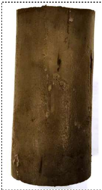
Zdjęcie – próbka B przed ścięciem
