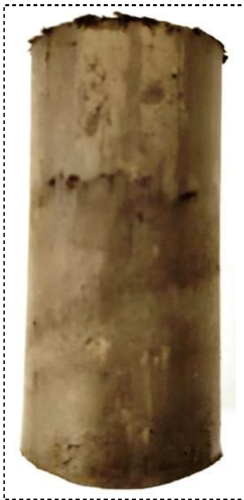
Zdjęcie – próbka C przed ścięciem
