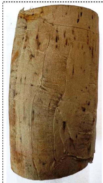
Zdjęcie – próbka B po ścięciu
