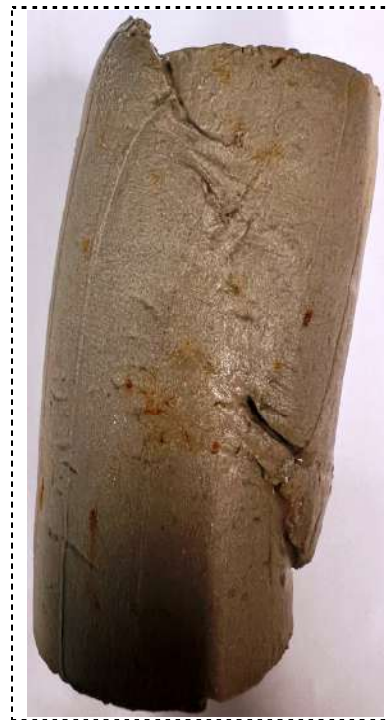
Zdjęcie – próbka B po ścięciu
