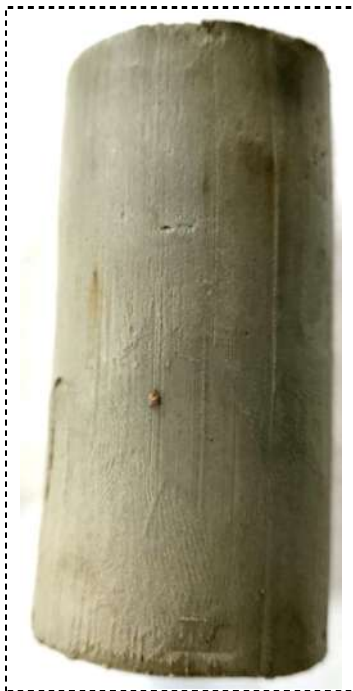
Zdjęcie – próbka A przed ścięciem
