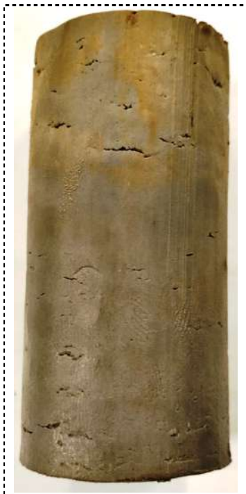
Zdjęcie – próbka C przed ścięciem
