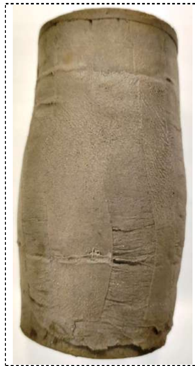
Zdjęcie – próbka A po ścięciu
