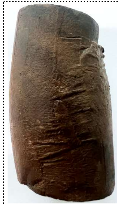
Zdjęcie – próbka A po ścięciu
