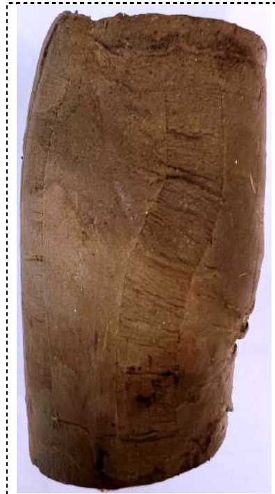
Zdjęcie – próbka C po ścięciu
