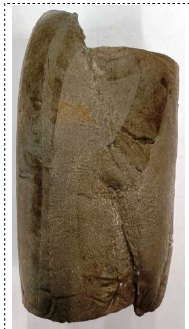
Zdjęcie – próbka C po ścięciu
