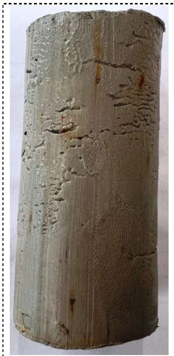
Zdjęcie – próbka B przed ścięciem
