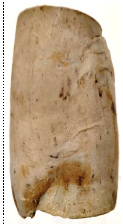
Zdjęcie – próbka A po ścięciu
